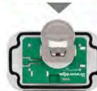
③ 本体裏面にてプラスドライバーを使用しネジ（4箇所）を締めます ※
