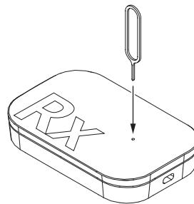
同梱されているスイッチ押しピンを使用し、本体表面の穴に挿入します。
